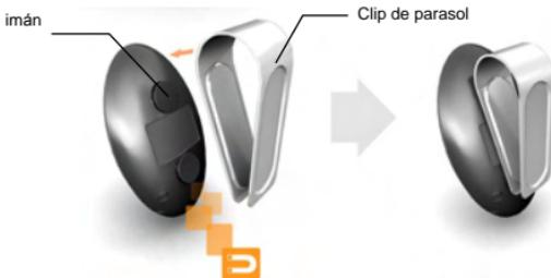
Figura 2 Fijación del clip de parasol
