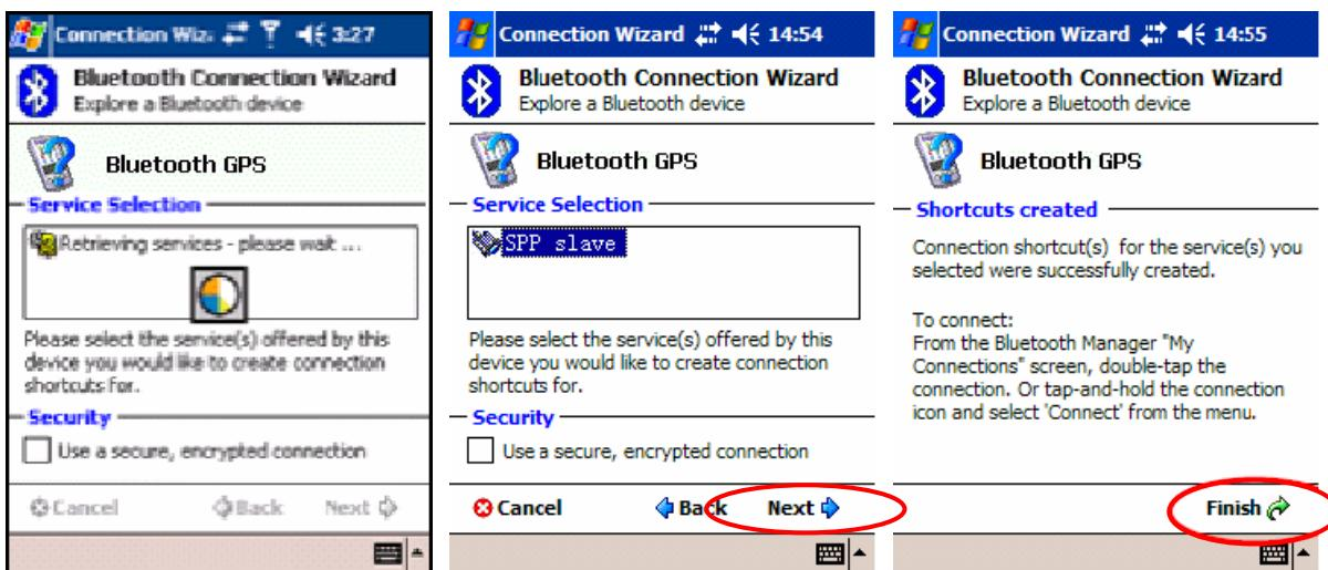
7.) Vuelva a la pantalla principal del “Bluetooth manager” como se indica a continuación. Haga doble clic sobre el icono para conectar la Antena GPS Bluetooth. Si la conexión se realiza con éxito, aparecerá una flecha verde como se muestra en la imagen de abajo a la derecha.
