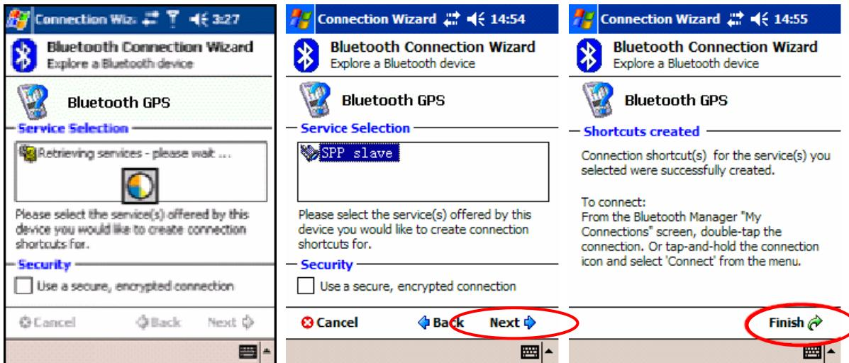
7.) Volte ao ecrã principal do “Bluetooth manager” (gestor Bluetooth) conforme abaixo indicado. Faça um duplo clique sobre o ícone para ligar o receptor GPS Bluetooth. Se a ligação for efectuada correctamente, surgirá uma seta verde conforme a figura em baixo à direita.
